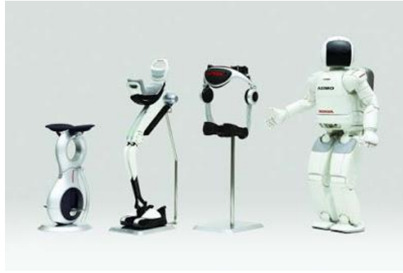
นวัตกรรมยานยนต์ส่วนบุคคล U3-X ที่พัฒนามาจากหุ่นยนต์ อาซิโม
